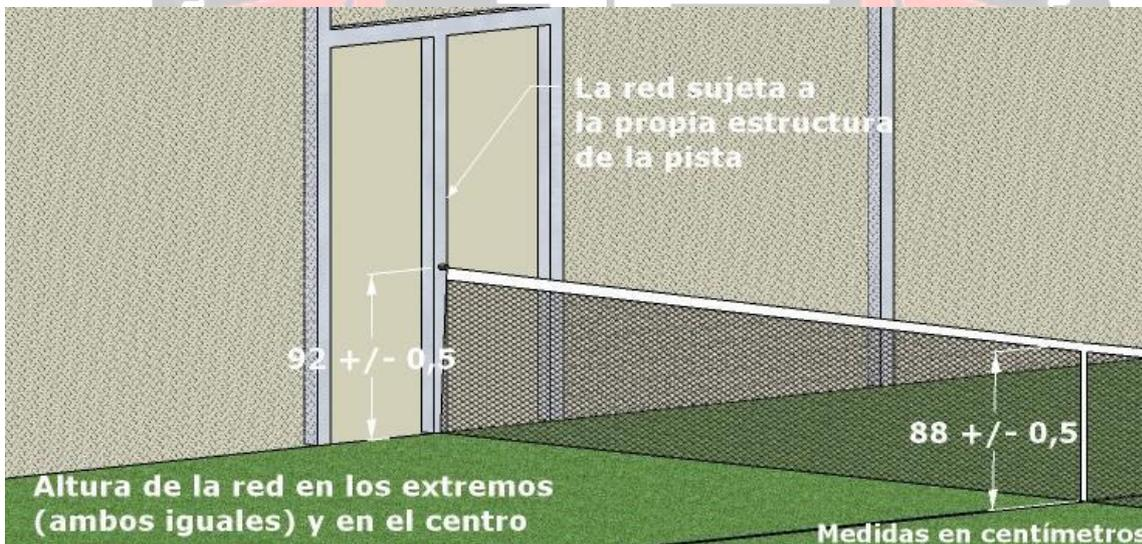
Se encuentra suspendida por un cable metálico de diámetro máximo 0,01 metros, cuyos extremos están unidos a dos postes laterales de una altura máxima de 1,05 metros o de la propia estructura que lo sujetan y tensan.
